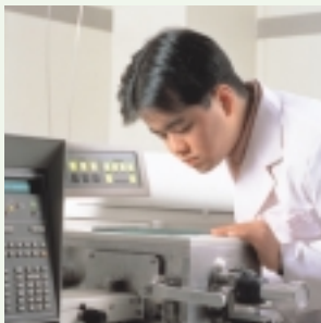
高分解能GC / MSを用いてダイオキシン分析を行っています
