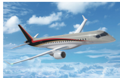
尾翼部品に炭素繊維複合材料を使用した国産 ジェット機「MRJ」 画像提供：三菱重工業(株)
