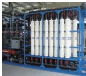
東レのUF膜が搭載された実証テスト装置 ※UF膜での水処理は、下廃水を飲用化する工程の一部です。
