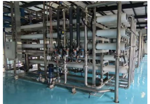
東レRO膜を使用した東麗酒伊織染（南通）有限公司での染色排水の再利用
